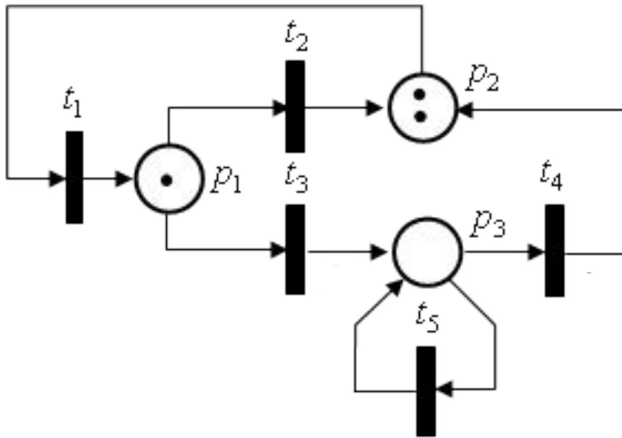
К подклассу **маркованных графов** относятся сети Петри, в которых каждая позиция имеет только один вход и один выход. Маркованные графы являются двойственными по отношению к автоматным графикам. Они позволяют моделировать параллельность и синхронизацию, но не могут моделировать конфликты или принятие решений, зависящих от данных. Наиболее интересными структурными компонентами маркованных графов являются циклы.
