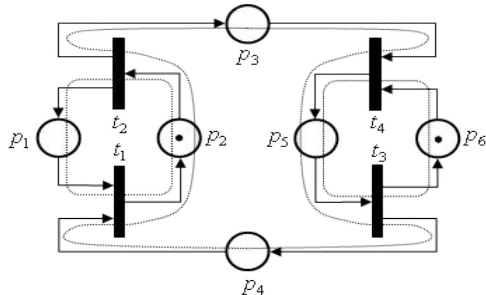
К подклассу ***устойчивых сетей Петри*** относятся сети, которые обладают следующим свойством: если при любой маркировке  $\mu$  два любых перехода  $t_i$  и  $t_j$  оказываются разрешенными, то срабатывание одного из них не исключает возможности срабатывания другого перехода.
