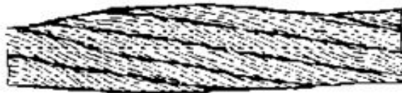
д) местное увеличение диаметра каната
