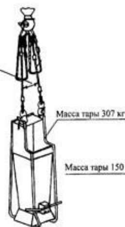
Строп 4СК1-10,0 Q=10,0 тс при подаче бункера(балды) с бетонной смесью V=1 м 3 Р=3,0 т
