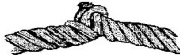
ж) перекручивание каната
