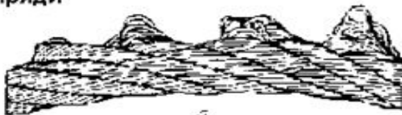
г) выдавливание проволок в нескольких прядях
