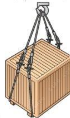
Строповка двумя двухпетлевыми стропами оборудования в деревянной таре
