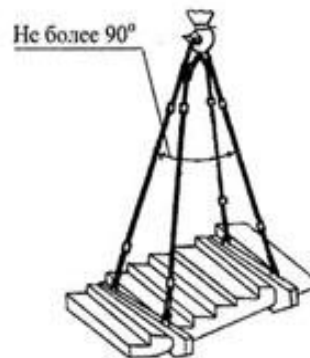
Строп 4 СК1-3,2+4 СК1-10,0 Q = 3,2 + 10,0 тс при подаче ящика с цементным раство- ром емкостью 0,28 м 3 P = 0,65 т
