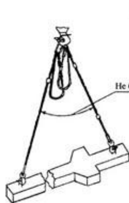
Строп 4СК1-3,2 4СК1-5,0 4СК1-10,0 4СК1-10,0 4СК1-10,0 (2СК-5,0) (2СК-5,0) (2СК-5,0) Q=3,2+10,0 тс Q=5,0+10,0 тс при разгрузке колонн
