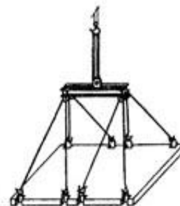
Траверса Т-1 Q=8,0 тс при монтаже плит
