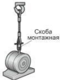
Строповка электродвигателя двухпетлевым стропом
