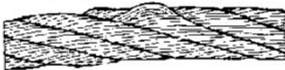
в) выдавливание проволок в одной пряди
