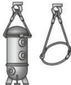
Строповка сосуда двумя двухпетлевыми стропами
