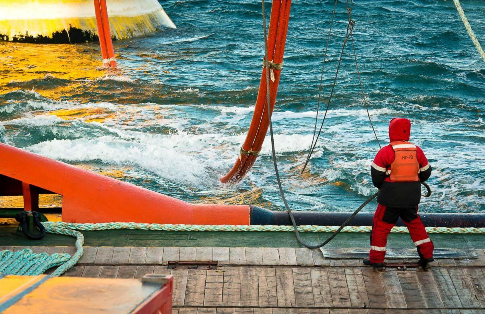
Конец свободно плавает в воде и вот снова на горизонте буксир "Смит Новик". У него важная миссия: подобрать конец из воды, зарядить в стреляющее устройство и выпустить пластмассовый снаряд с концом на нос танкера, где его закрепят, установив соединение с платформой. От грамотности действий экипажа этого буксира будет зависеть весь успех операции.
