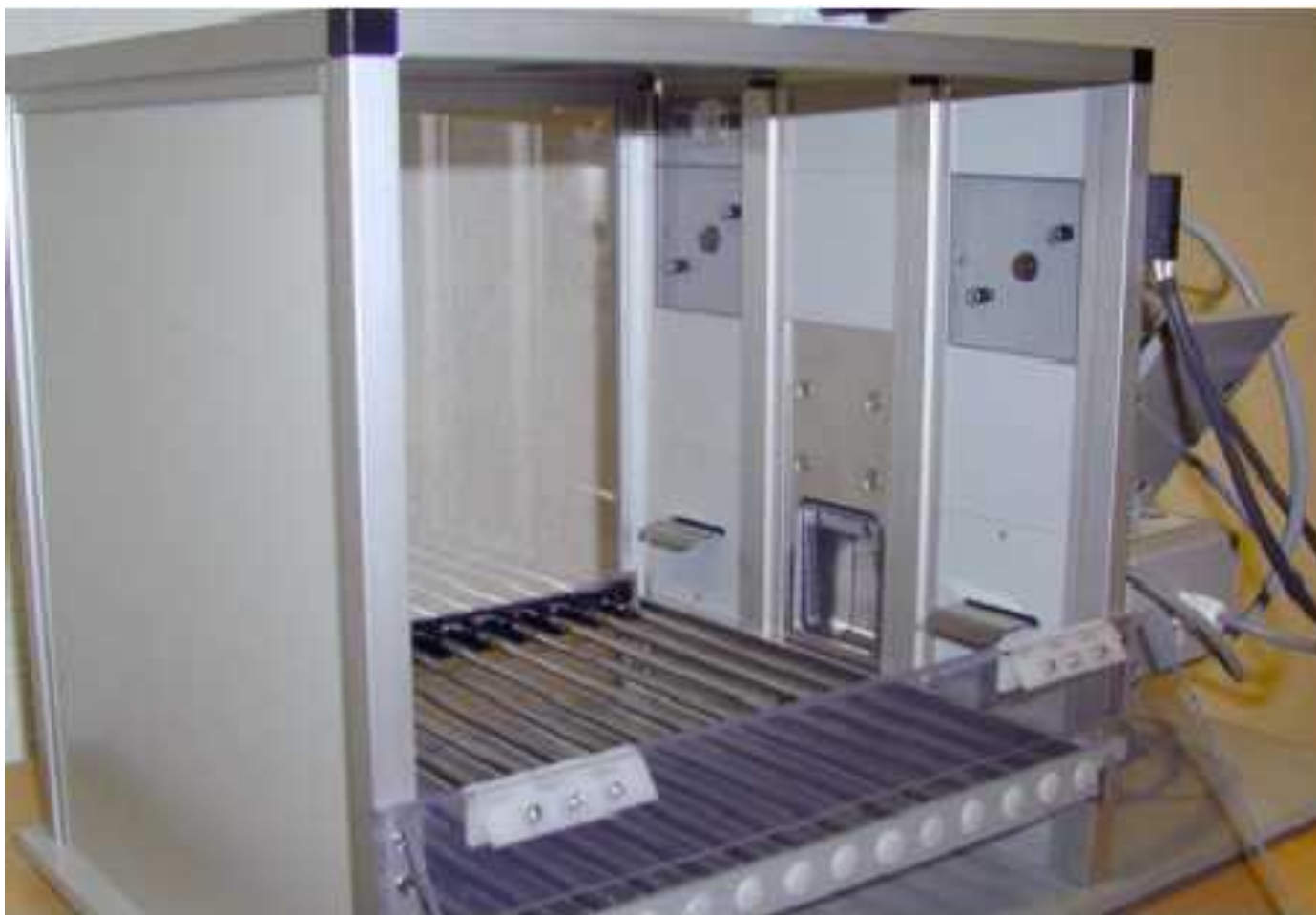
Экспериментальная камера («камера Скиннера») с двумя рычагами, двумя лампочками, верхней подсветкой, электропроводным полом и автоматической кормушкой (TSE Systems)
