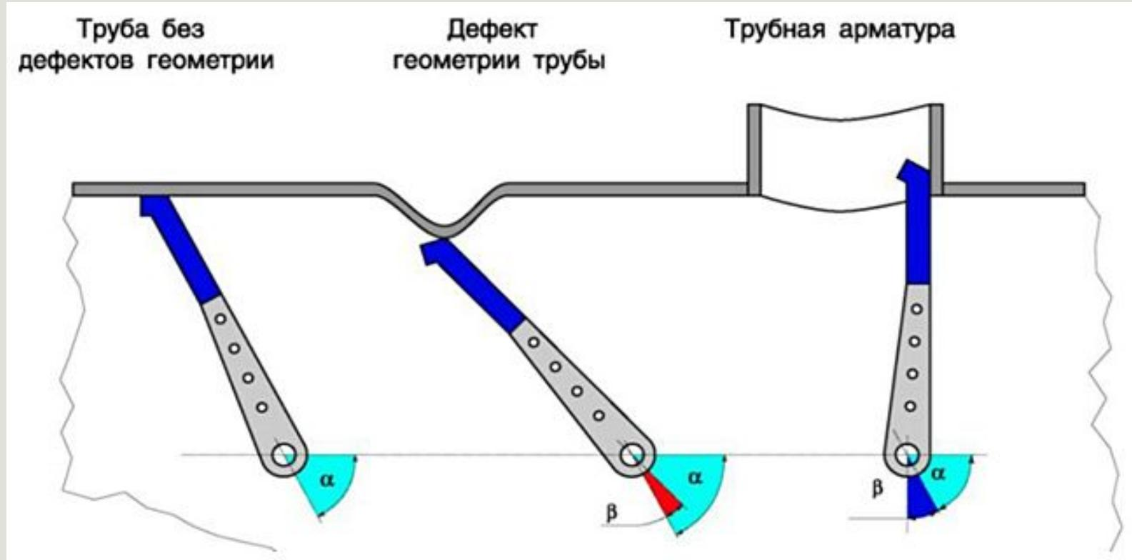
$\alpha$  – нормальное положение рычага;  $\beta$  – угол отклонения рычага
