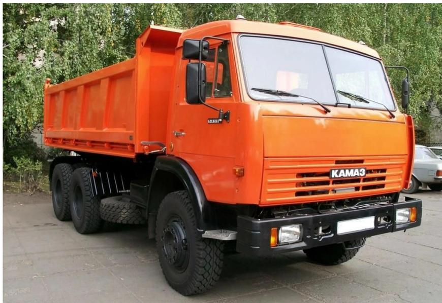
Рисунок 1.6 – Автомобиль-самосвал КамАЗ 45142
