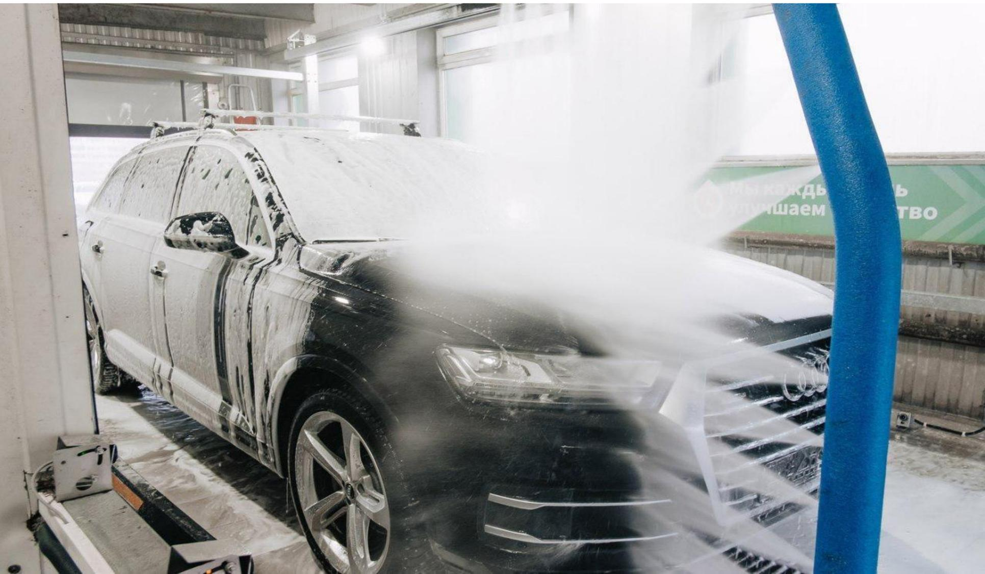
При удалении грязи моющей жидкостью происходит следующее: водный раствор СПАВ растекается по омываемой поверхности, смачивает ее и проникает в поры частиц загрязнений, способствуя нарушению связи между ними. Чем меньше поверхностное натяжение моющего раствора, тем больше способность смачивать загрязненную поверхность и тем эффективнее действует на загрязнения раствор моющего средства
