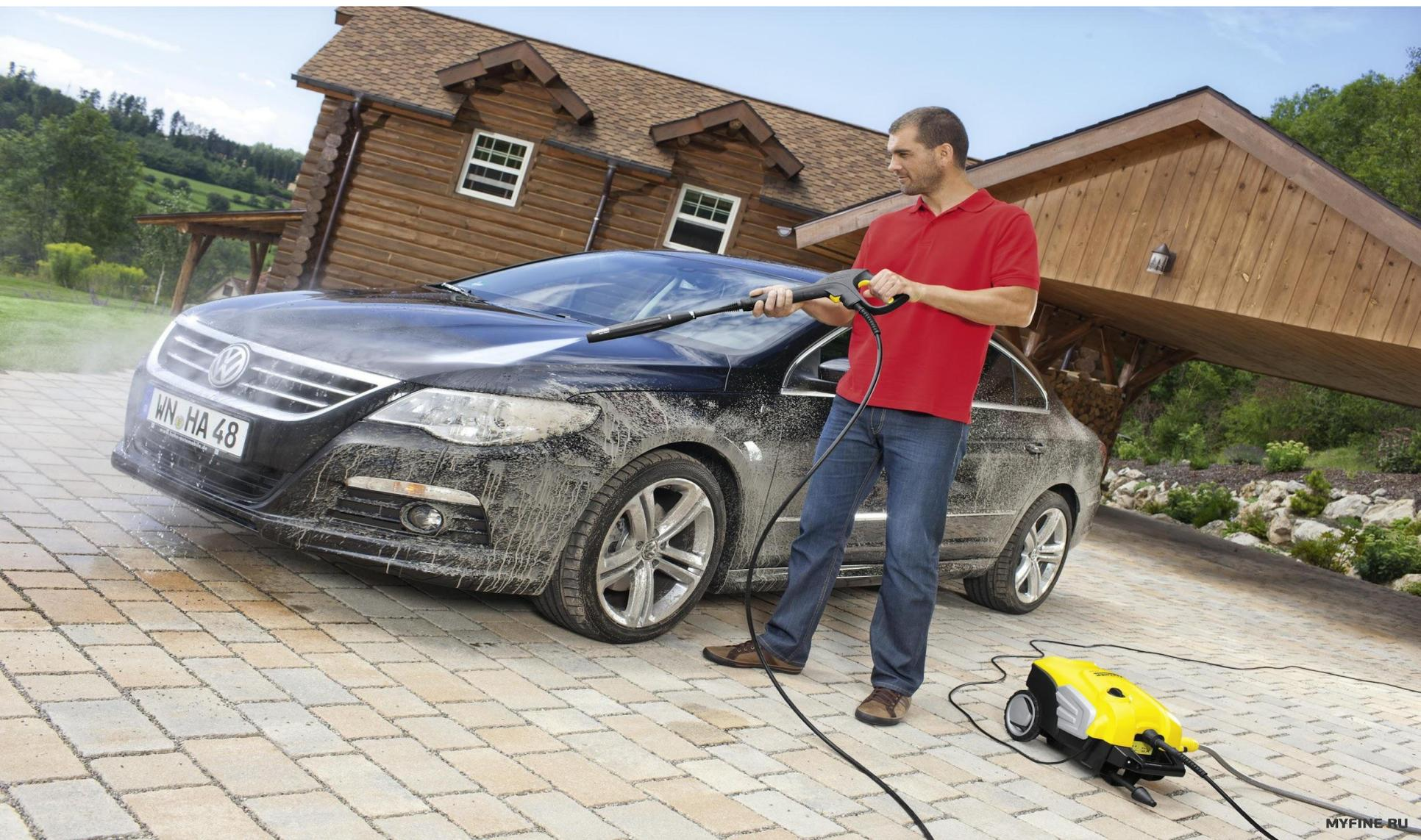
Для достижения удовлетворительного качества мойки автомобилей водяной струей расходуется большое количество воды. Так, в среднем при давлении воды 1,5 МПа расход на один легковой или грузовой автомобиль составляет от 200 до 250 л, а на автобус – 300...400 л.
