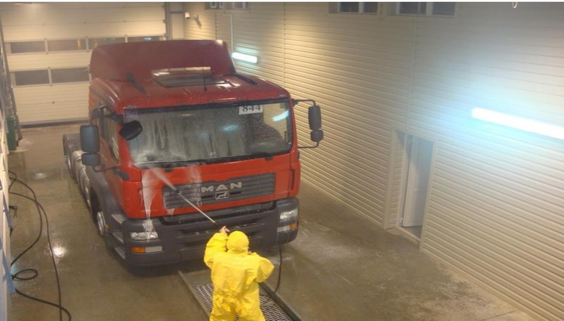
В то же время этот пограничный слой (мертвая зона) не дает потоку воды, обладающему большой скоростью, соприкоснуться с обмываемой поверхностью, а следовательно, удалять имеющиеся загрязнения
