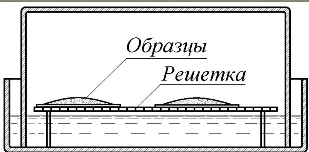
Рис. 3.3. Ванна с гидравлическим затвором
