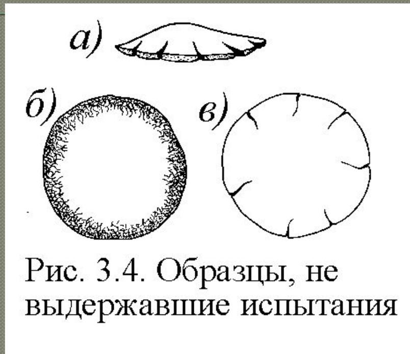
Рис. 3.4. Образцы, не выдержавшие испытания
