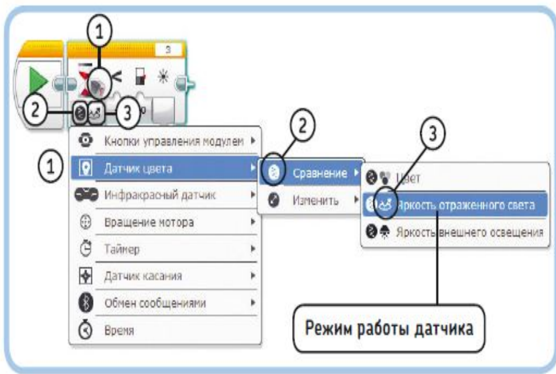
Рис. 6.18. Если в примерах программ в этой книге используются блоки Ожидание , Цикл и Переключатель , выбирайте пункты меню так, чтобы они совпадали со значками, показанными на блоках. Начните с выбора подходящего датчика (1), выберите способ взаимодействия, Сравнение , Изменить или Измерение (2), и, наконец, выберите режим работы датчика (3)
