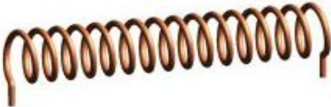
Соленоид (от греч. *solen* — «канал», «труба» и *eidos* — «подобный») — разновидность катушки с током. Обычно под термином «соленоид» подразумевается цилиндрическая обмотка из провода, причём длина такой обмотки многократно превышает её диаметр.
