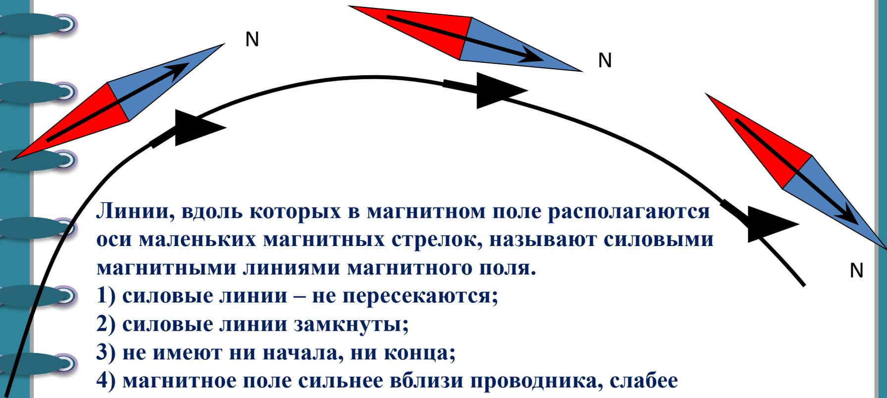
Линии, вдоль которых в магнитном поле располагаются оси маленьких магнитных стрелок, называют силовыми магнитными линиями магнитного поля.
