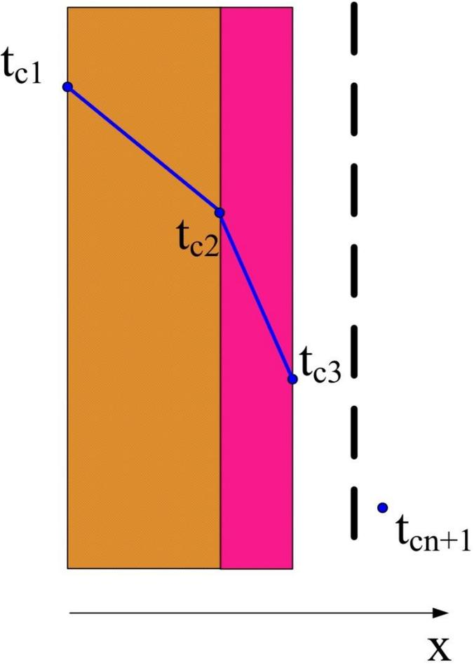
Определяем плотность теплового потока через многослойную стенку толщиной  $\delta_1, \delta_2, \dots, \delta_n$ , на поверхностях которой поддерживаются постоянные температуры.
