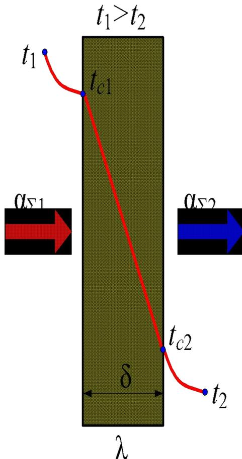
Схема теплопередачи через плоскую однородную стенку:
