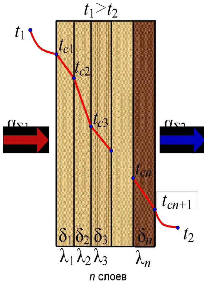
Схема теплопередачи через плоскую многослойную стенку:
