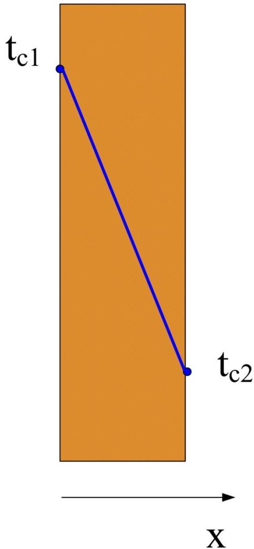
Определяем плотность теплового потока через стенку толщиной  $\delta$ , на поверхностях которой поддерживаются постоянные температуры.
