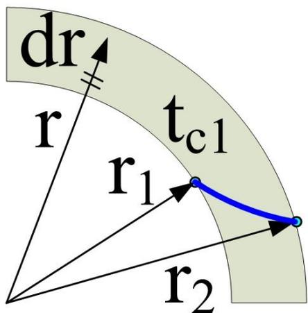
Определяем плотность теплового потока через сферическую стенку радиусами  $r_1$ ,  $r_2$ , на поверхностях которой поддерживаются постоянные температуры.
