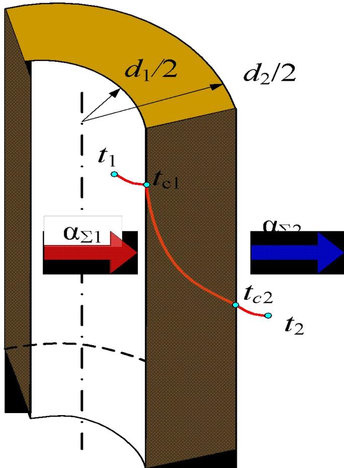
Схема теплопередачи через цилиндрическую однородную стенку:
