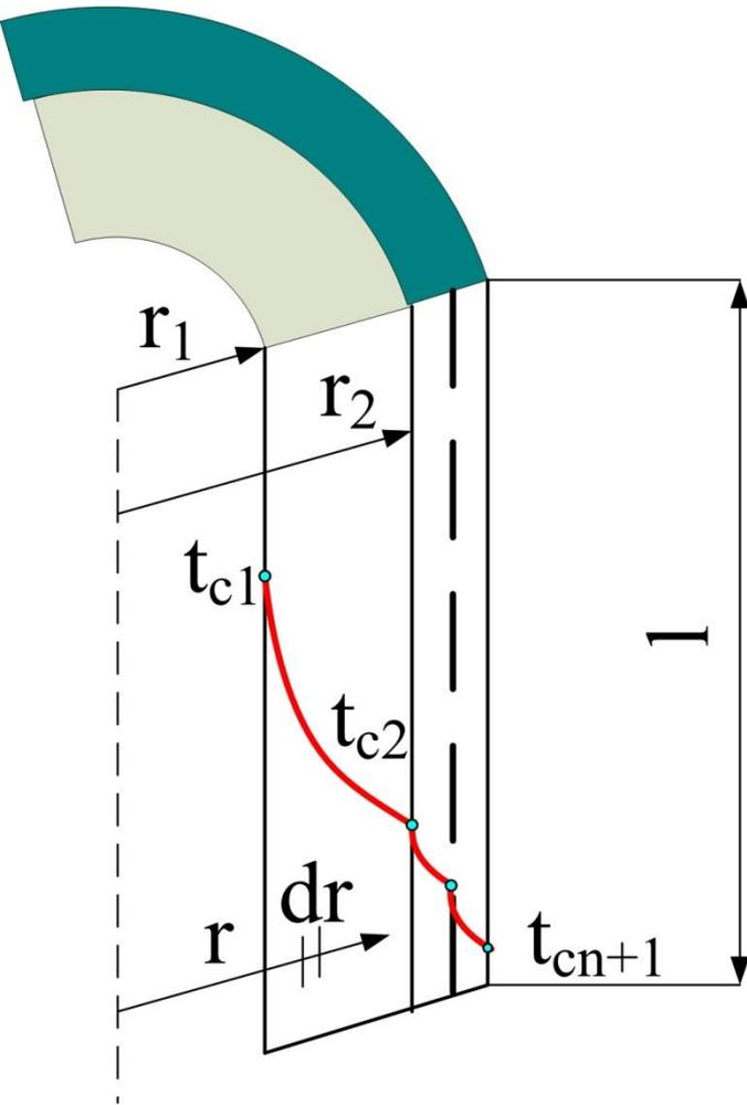
Определяем плотность теплового потока через многослойную цилиндрическую стенку радиусами  $r_1, r_2, \dots, r_n$ , на поверхностях которой поддерживаются постоянные температуры.
