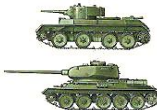
Танки: 1 — легкий танк БТ-7 (1935); 2 — средний танк Т-34-85 (1944).
