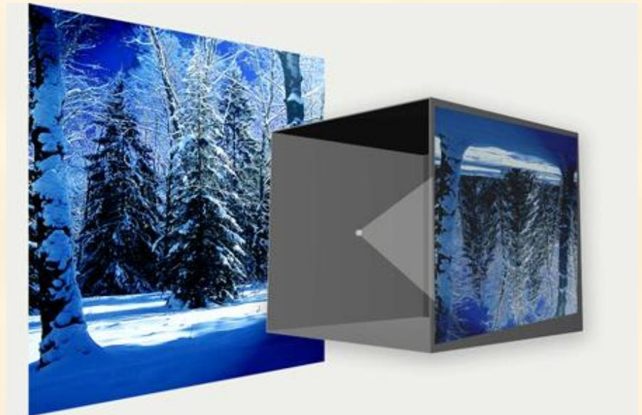
Камера-обскура не обеспечивает высокой резкости изображения.
