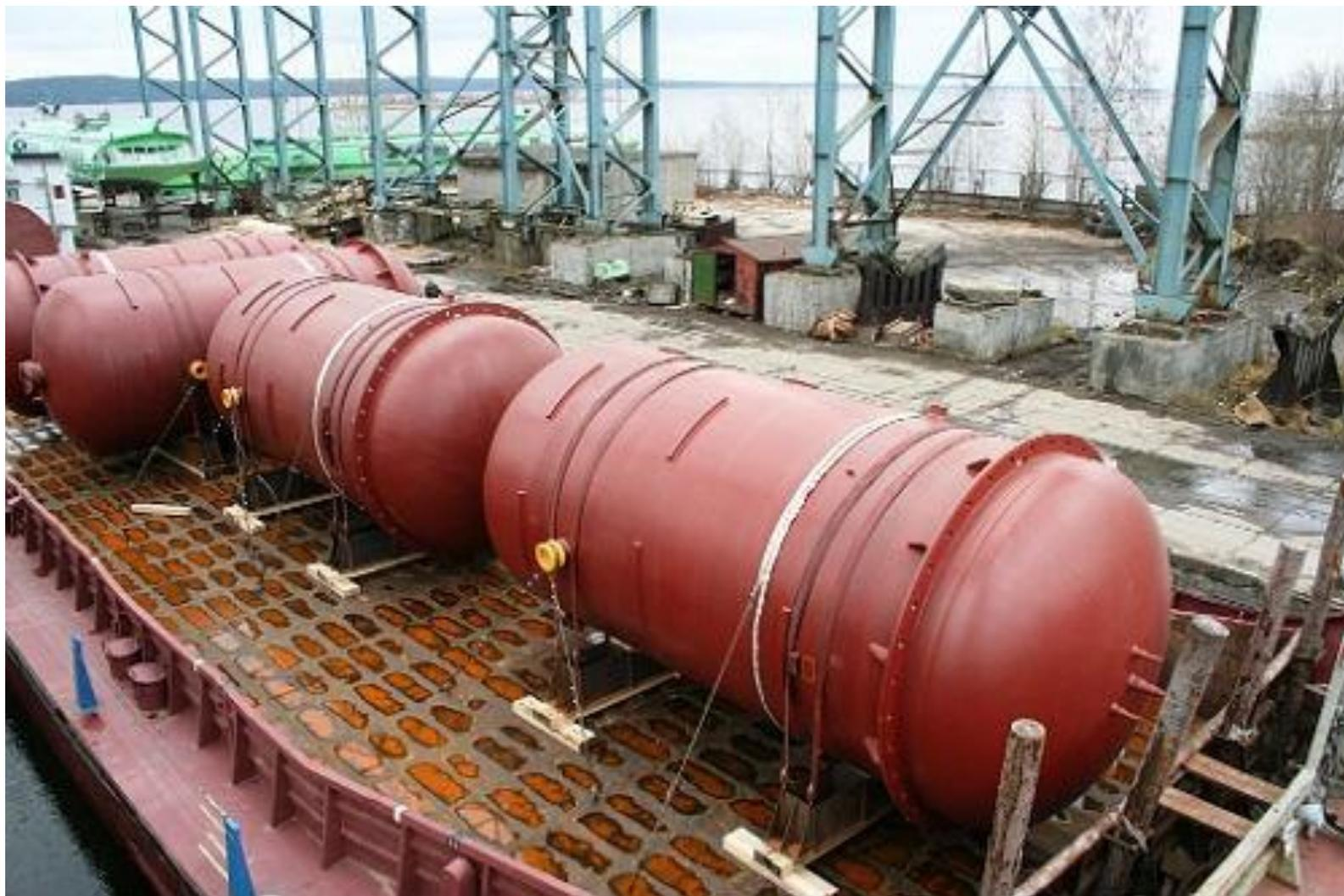
Гидроемкость СПЗА3 представляет собой цилиндрический сосуд объемом 120 кубометров и весом около 80 тонн. Оборудование монтируется в гермозоне на отметке +26,3 метра. Все гидроемкости системы пассивного залива активной зоны для первого и второго энергоблоков Нововоронежской АЭС-2 изготовлены ЗАО «Петрозаводскмаш» (входит в группу компаний «Атомэнергомаш»).
