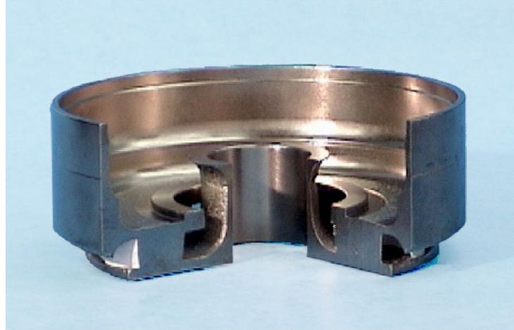
Диффузор затем преобразует эту кинетическую энергию в потенциальную, создавая давление на выходе насоса.
