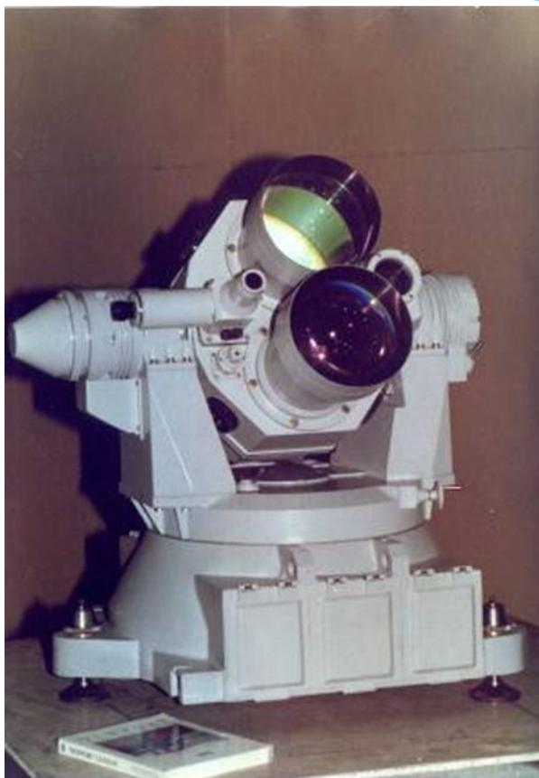
Оптическая система приемного канала предназначена для сбора отраженного лазерного излучения и формирования его на чувствительной площадке фотоприемного устройства. Оптическая схема приемного канала включает в себя:
