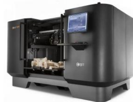
Промышленный принтер Objet 1000; область построения 1000*800*500 мм
