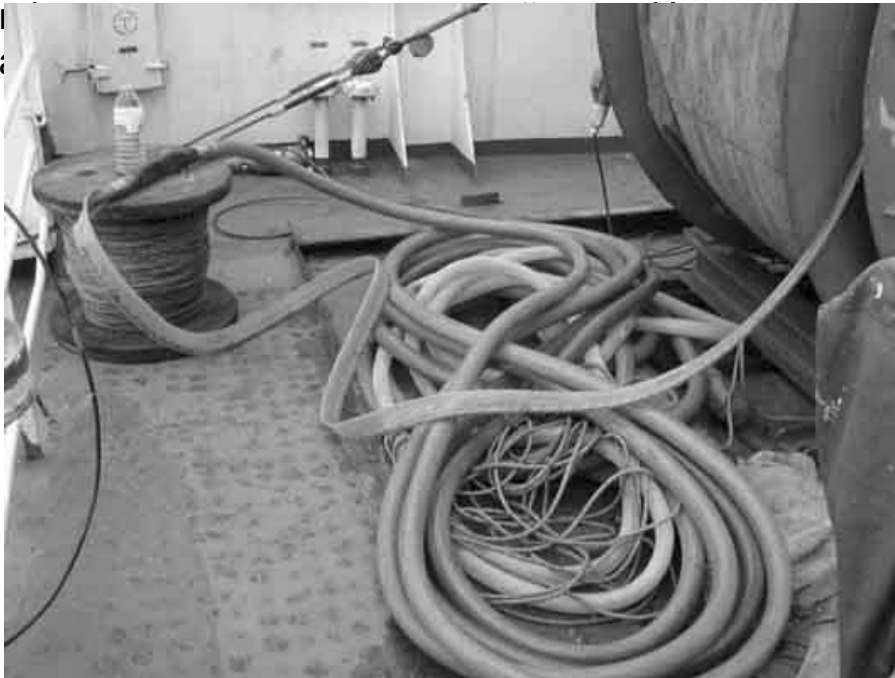
Приемная антенна для непрерывного сейсмического профилирования (<сейсмическая коса>)
