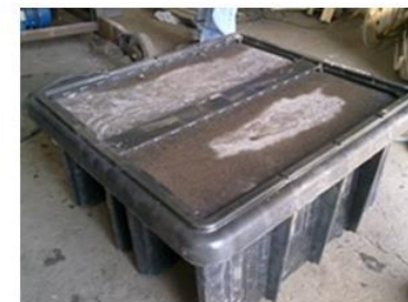
Формы для бетона
