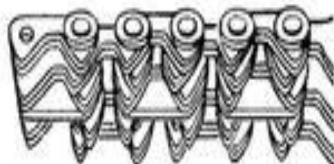
Соединительное звено, используемое при четном числе звеньев цепи, отличается от обычного наружного тем, что одна из его пластин надевается на концы валиков свободно и фиксируется на валиках замками и шплинтами. В случае необходимости использования цепи с нечетным числом звеньев применяют изогнутые переходные звенья, которые являются слабым местом цепи.
