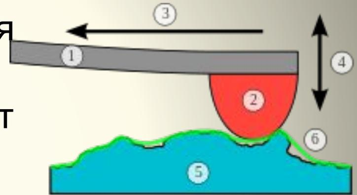
В [технике](#) профилометры в основном предназначены для измерений в лабораторных и цеховых условиях машиностроительных, приборостроительных и других предприятий, а также в полевых условиях, шероховатости поверхностей изделий, [сечение](#) которых в плоскости измерения представляет [прямую линию](#). Измерение параметров шероховатости поверхности производится по системе [средней линии](#) в соответствии с номенклатурой и диапазонами значений, предусмотренными [ГОСТ](#) 2789-73.
