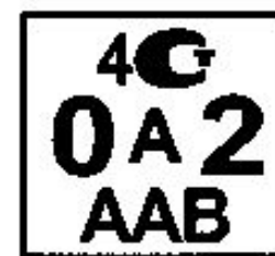
Рис. 8.11 — Поверительное клеймо, применяемое метрологической службой юридического лица при клеймении средств измерений, находящихся в эксплуатации или после ремонта
