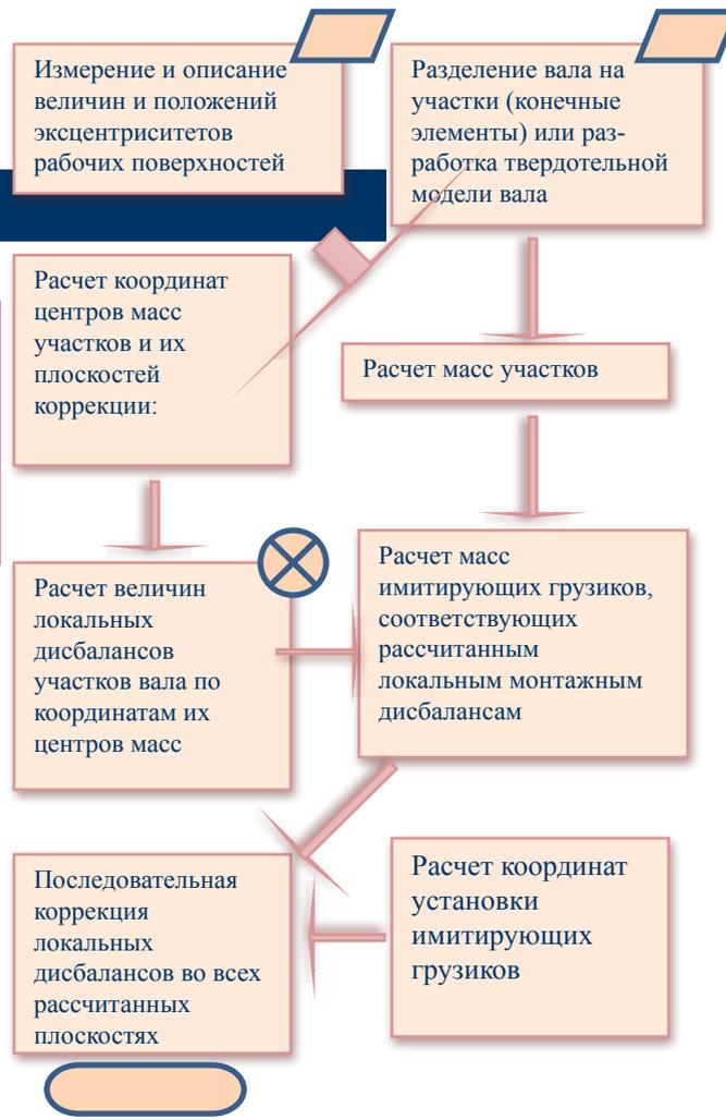
Схема определения исходных данных для расчетов
