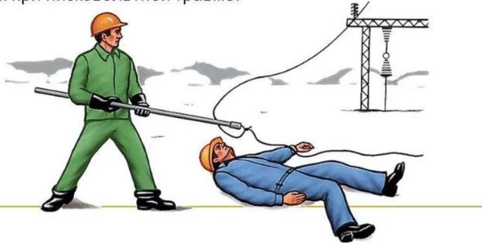
При несчастных случаях для освобождения пострадавшего от действия электрического тока напряжение должно быть снято немедленно без предварительного разрешения руководителя работ
