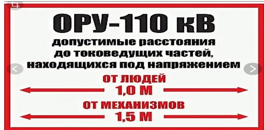
В электроустановках не допускается приближение людей, механизмов и грузоподъемных машин к находящимся под напряжением неогражденным токоведущим частям на расстояния менее указанных в таблице 1.1
