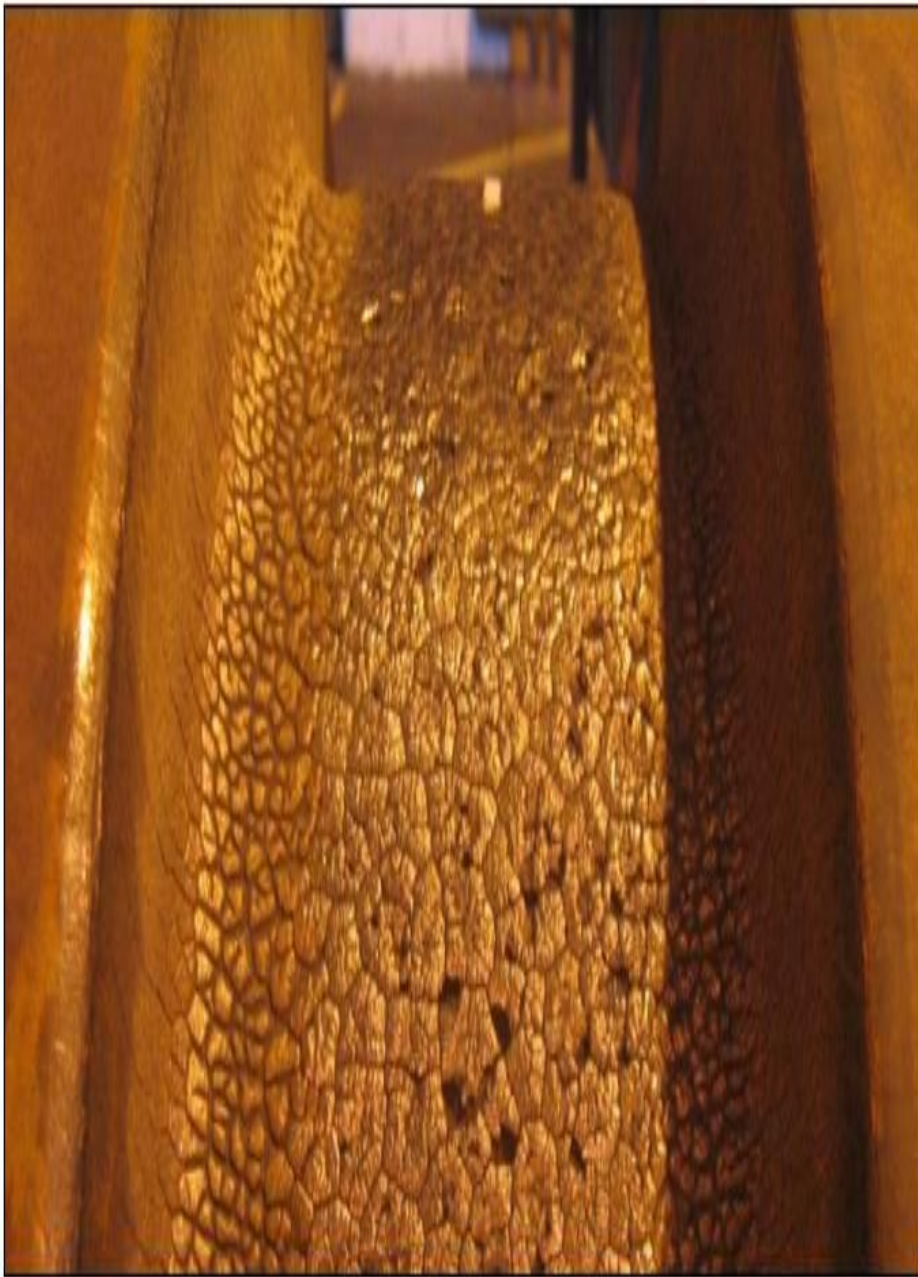
Сетка разгара на дне ящичного калибра сортопрокатного валка
