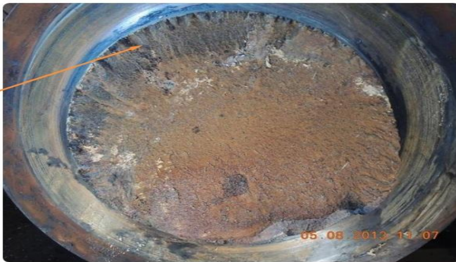
Очаг усталостного разрушения
