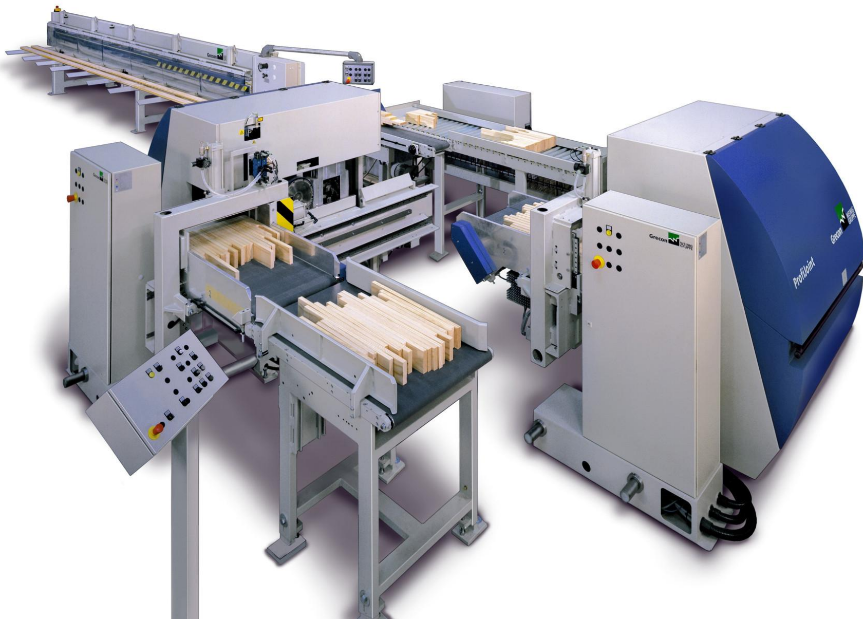
Линия сращивания деталей на минишип (Грекон-Димтер)
