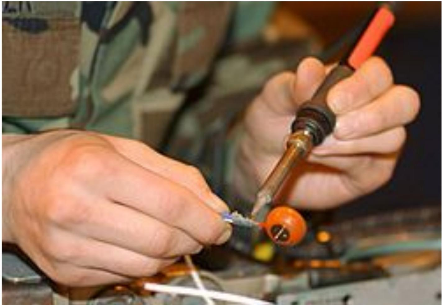
Пайка — технологическая операция, применяемая для получения неразъёмного соединения деталей из различных материалов путём введения между этими деталями расплавленного материала (припоя), имеющего более низкую температуру плавления, чем материал (материалы) соединяемых деталей.
