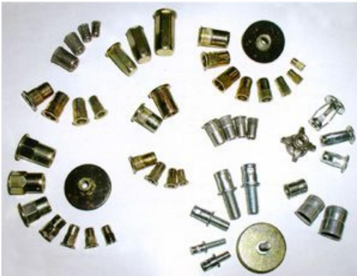
Заклепочные гайки и болты являются эффективным решением для получения наружной или внутренней резьбы на тонкостенной детали, в том числе и цилиндрической. Они устанавливаются в предварительно подготовленное (пробитое или просверленное) отверстие с одной стороны, обжимаются вытягиванием штока инструмента с формированием с обратной стороны замыкающего бортика. Материал: сталь, нержавейки, алюминия и бронзы.
