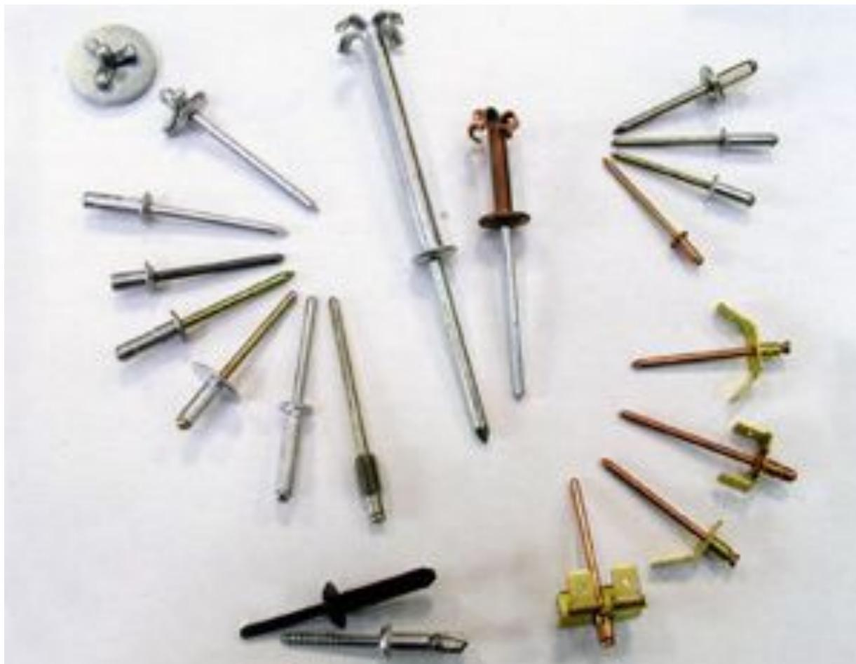
Позволяют осуществить неразъемное соединение с доступом только с одной стороны. Они производятся различной длины и диаметров, бывают с куполообразным (стандартным), увеличенным и потайным бортиком, могут быть из алюминия, стали, нержавеющей стали, меди, в зависимости от вида применения. Для некоторых применений имеют специальную конструкцию: закрытые, многозажимные, лепестковые, рифленые, контактные и самоперфорирующие.
