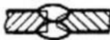
Нахлѐсточное — сварное соединение, в котором сваренные элементы расположены параллельно и частично перекрывают друг друга.
