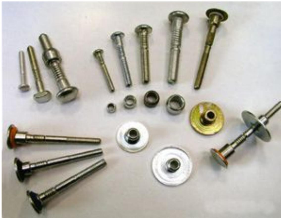
Это система быстрой установки для сборки частей испытывающих высокие механические нагрузки или подвергающиеся высокой вибрации. Состоят из штифта и обжимающего кольца, штифт имеет насечки для жёсткой фиксации обжимного кольца. При установке требуется доступ с обратной стороны. Выпускаются различных длин и диаметров, в зависимости от толщины пакета и нагрузок. Материал: сталь, алюминий и нержавейка.
