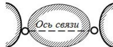
**Связь второго вида** – цилиндрический шарнир (в дальнейшем будем называть «шарнир») (рис. 2.9, *а*). Такая связь эквивалентна шарнирной неподвижной опоре (рис. 2.9, *б*) или двум связям первого вида, пересекающимся в одной точке (рис. 2.9, *в*, *г*), которая может играть роль действительного (рис. 2.9, *в*) или фиктивного (рис. 2.9, *г*) шарнира.
