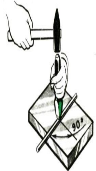
Рис. 17. Разрезание проволоки зубилом.
