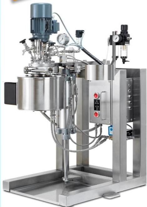
*Сотрудники сектора принимают самое активное участие во всех работах, связанных с усовершенствованием технологии производства ПНД и улучшением качества продукции. На лабораторной установке с реактором-автоклавом проводятся испытания новых перспективных катализаторов полимеризации этилена. В рамках импортозамещения испытано 5 катализаторов производства КНР и 2 катализатора отечественной разработки.*
