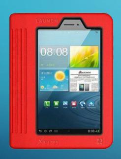
Информация выводиться на планшет под управлением операционной Android. Связь с планшетом обеспечивается посредством технологии Bluetooth.
