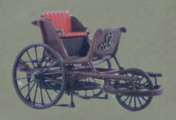
Русским изобретателем Иваном Кулибиным была изготовлена «самокатная повозка». Она вмещала двух человек. Привод был педальный. На коляске был установлен механизм, который напоминал современную коробку передач. Можно было изменять скорость, и увеличивали мощность. Также был тормоз на задние колеса. Руль, которым управлялась повозка, был похож на корабельное приспособление.
