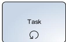
**Циклическое действие (loop activity)** выполняется, пока условие цикла верно. Условие цикла может проверяться до или после выполнения действия.
