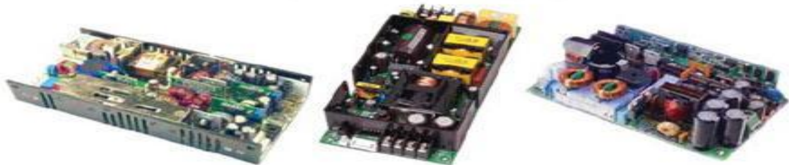
Рис. 48. Структура и внешний вид импульсных источников питания
