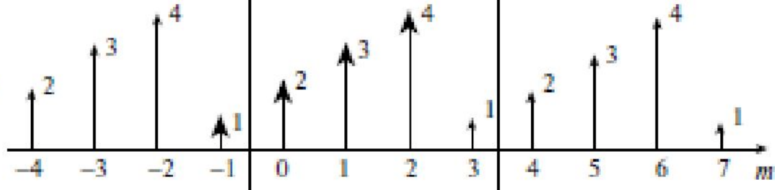
Рис. 11.5. Свертка y(m) последовательностей h(n) и x(n)
