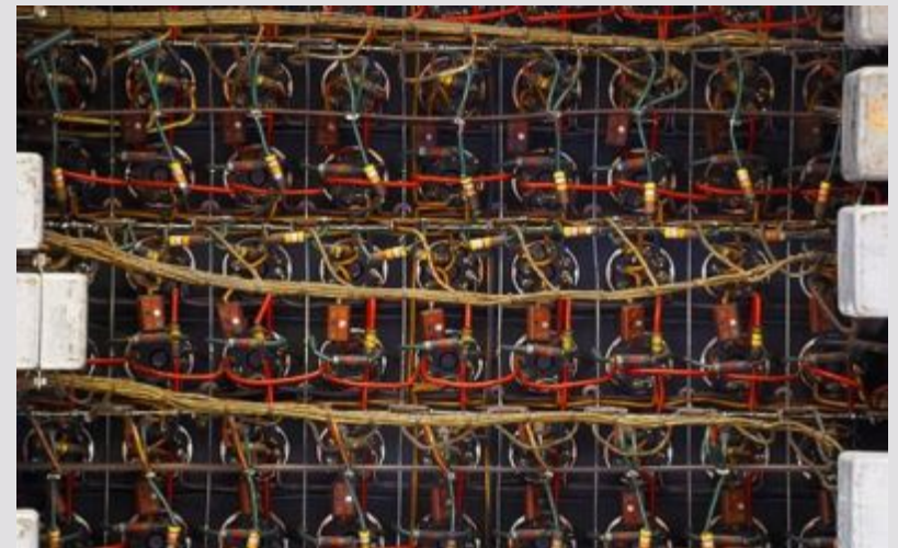
Монтаж электронных ламп на компьютерах первого поколения
