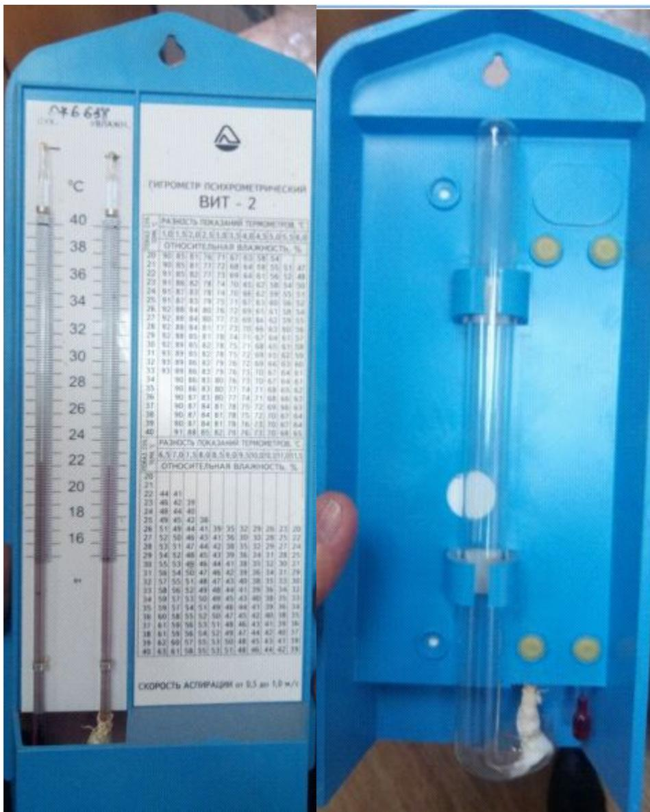
*В помещениях РТУ СЦБ при проверке приборов СЦБ не контролируется влажность воздуха, в гигрометрах психрометрических типа ВИТ отсутствует вода.*
