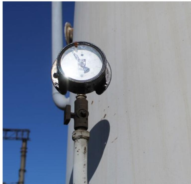
В нарушение требований федерального закона от 26 июня 2008 г. № 102-ФЗ сервисное локомотивное депо на ст.Улан-Удэ эксплуатирует газосварочное оборудование, воздушные резервуары, с установленными на них манометрами (переданы в содействие от ТЧэ-7), которые были откалиброваны в соответствии с договором. Данные манометры должны быть поверены, так как попадают в сферу государственного регулирования обеспечения единства измерений.
