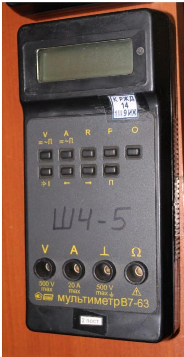
*На 2 посту ЭЦ ст. Иркутск-Сортировочный эксплуатируется 2 неисправных мультиметра В7-63 и 2 неисправных преобразователя тока селективных А9-1 Не включаются. Разряжены элементы питания.*
