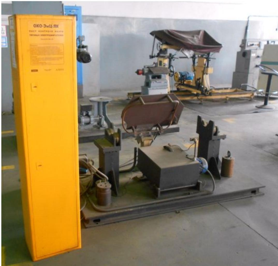
**В электромашинном отделении эксплуатируются метрологически непригодные посты контроля: остова тягового двигателя ОКО-ЭМЦ-ОС, балансировочный станок ОКО-ЭМЦ-СБ, входного контроля ОКО-ЭМЦ-ВХ, якоря тягового двигателя ОКО-ЭМЦ-ЯК.**
