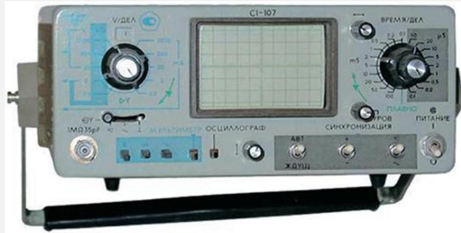
**Осциллограф** — прибор, предназначенный для исследования амплитудных и временных параметров электрического сигнала, подаваемого на его вход, либо непосредственно на экране, либо записываемого на фотоленте.
