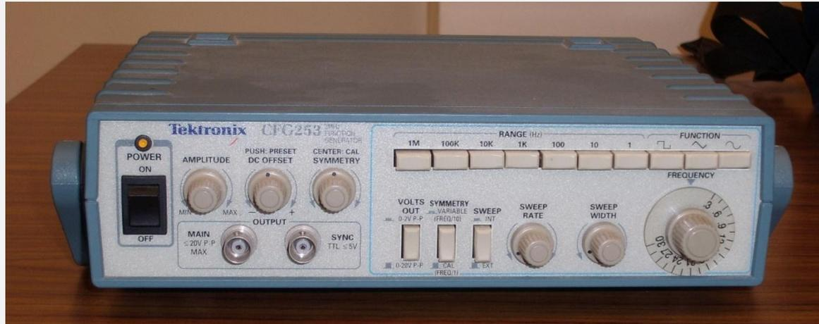
**Измерительный генератор** — электронное устройство, мера для воспроизведения электромагнитного сигнала (синусоидального, импульсного, шумового или специальной формы).
