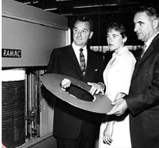
**1956 год:** первый жесткий диск был огромным шкафом, в котором находился пакет из 50 большущих пластин диаметром 24 дюйма (более 60 см) каждая.
