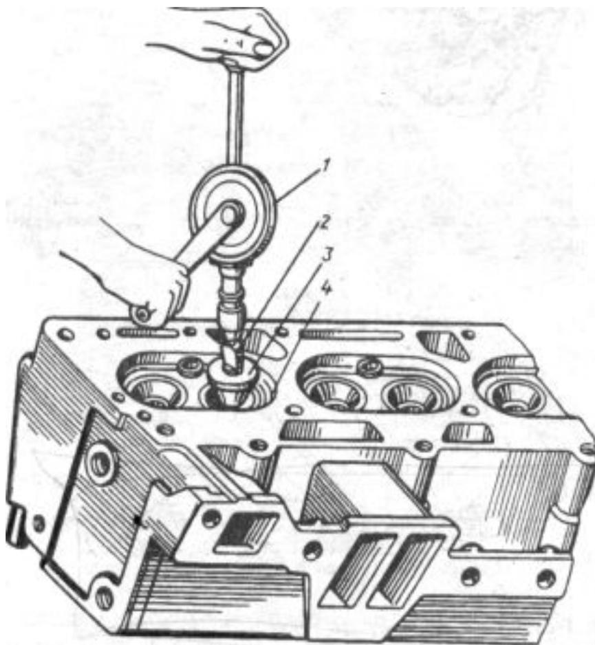
**Притирка клапанов с помощью дрели:**
