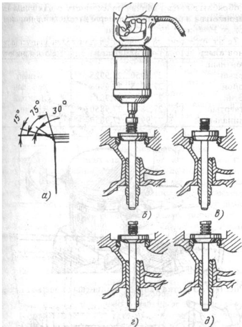
**Шлифование фасок седла клапана абразивными инструментами с разным углом наклона кромки:**
