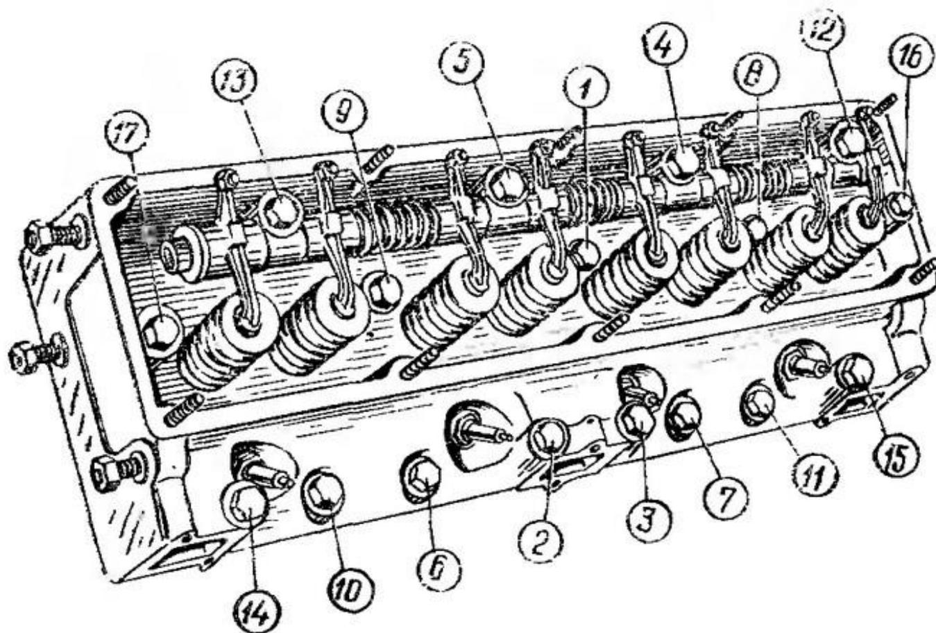
ЗАТЯЖКА БОЛТОВ КРЕПЛЕНИЯ ГОЛОВКИ ЦИЛИНДРОВ
