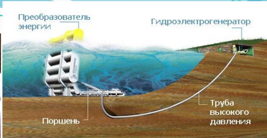
«Устрица» (Oyster) — самый крупный агрегат такого рода в мире, высотой с многоэтажный дом. Аппарат был водружён на морское дно и включён в потребительскую электросеть. Особенностью аппарата является большой поплавок-насос, который под действием волн качается и тем самым под высоким давлением гонит воду на подстанцию. Вода под давлением вращает турбину, которая и генерирует электричество.
