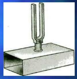
Ударив молоточком по ветви одного камертон ,мы обнаружим вскоре,что и второй камертон начинает звучать. Звуковая волна от первого камертона создает периодическую силу, действующую на второй камертон. Частоты колебаний камертонов одинаковы, и амплитуда колебаний второго камертона вследствие резонанса оказывается очень большой.
