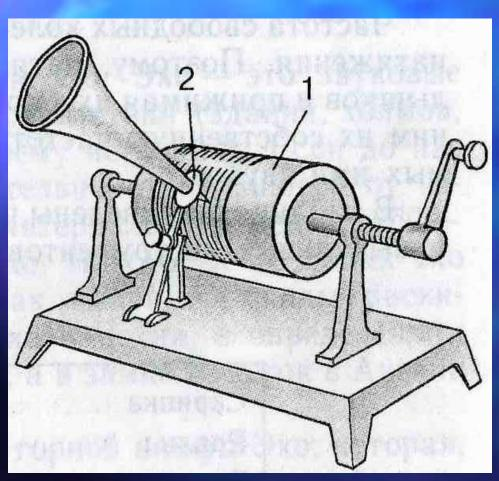
Фонограф предназначен для механической записи звука.
