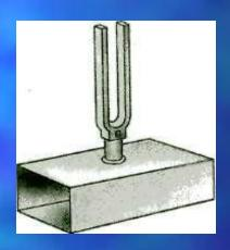
Если взять камертоны с различными собственными частотами, то второй камертон при возбуждении первого звучать не будет.
