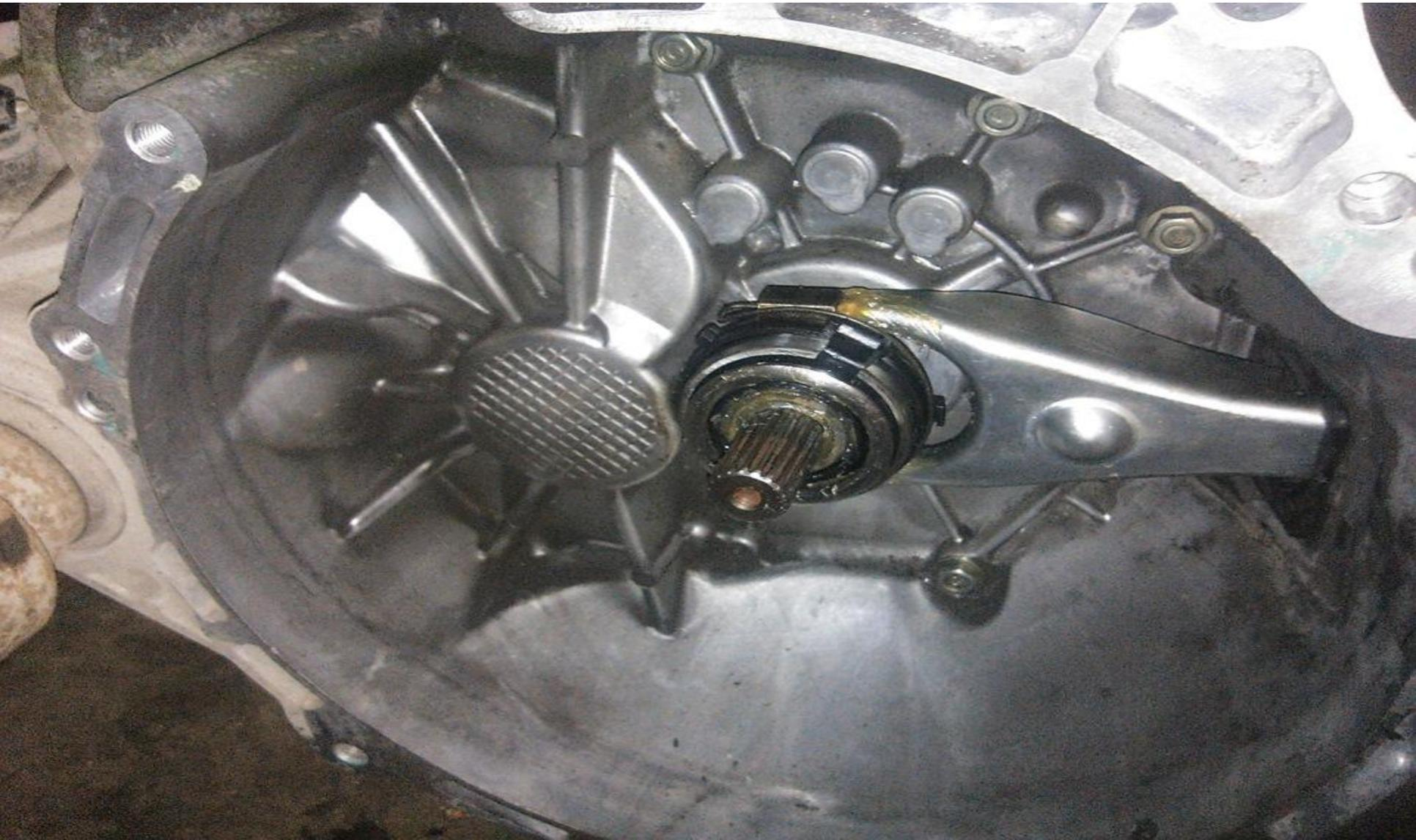
На легковых автомобилях применяют однодисковое фрикционное сцепление механическим приводом который состоит из.....
