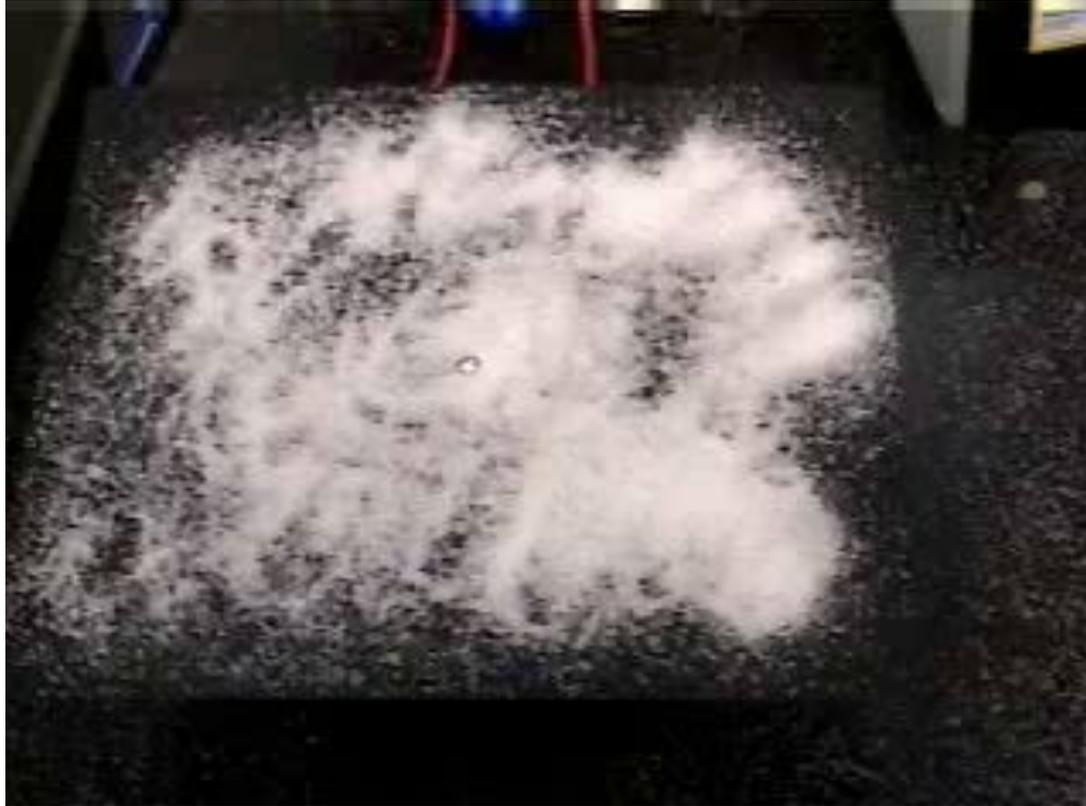
*Под воздействием звука разной частоты в однородной среде (частички сахара одинакового размера) возникает структура – частички сахара концентрируются в узлах двумерной стоячей волны на поверхности динамика*
