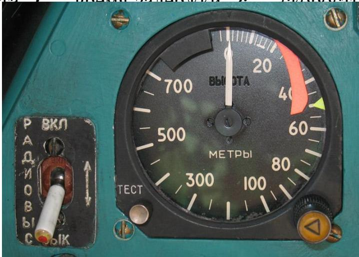
Радиовысотомер на панели приборов
