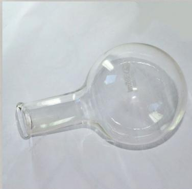
для нагревания растворов в разных химических процессах , при перегонке, в качестве приёмников.
