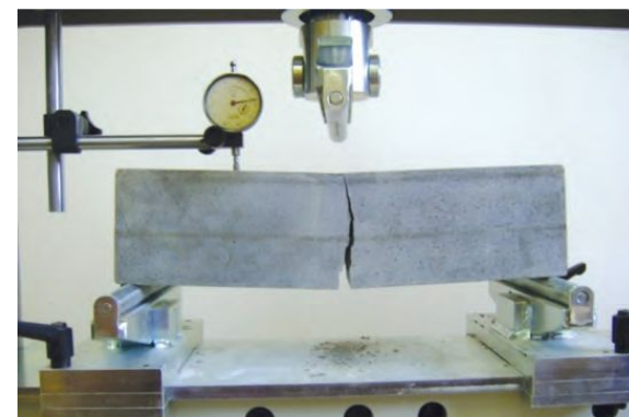
Рисунок 6 – Схема проведения испытаний трещиностойкости фибробетона, с применением индикатора часового типа
