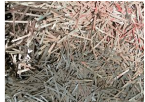
Рисунок 24 – фибра металлическая аморфная длиной 40 мм, толщиной 20 - 30мкм и шириной 2-3мм производства ООО «Химмет».
