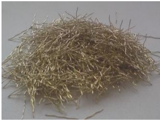
Рисунок 22 – фибра стальная проволочная круглого сечения волнового профиля диаметром 0,3мм и длиной 22мм производства Белорусского металлургического завода.
