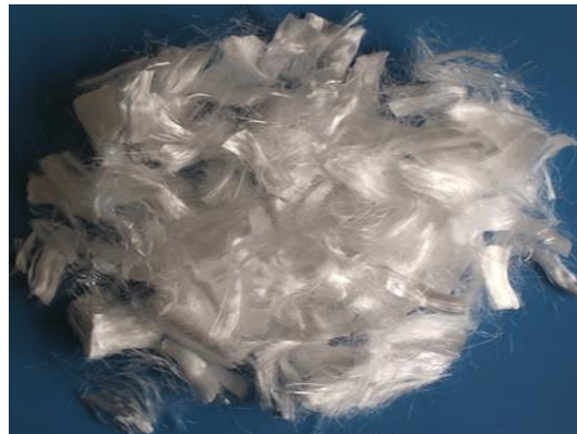
Рисунок 23 – фибра синтетическая полипропиленовая «Kalcifil S» длиной 12мм и диаметром 25мкм.
