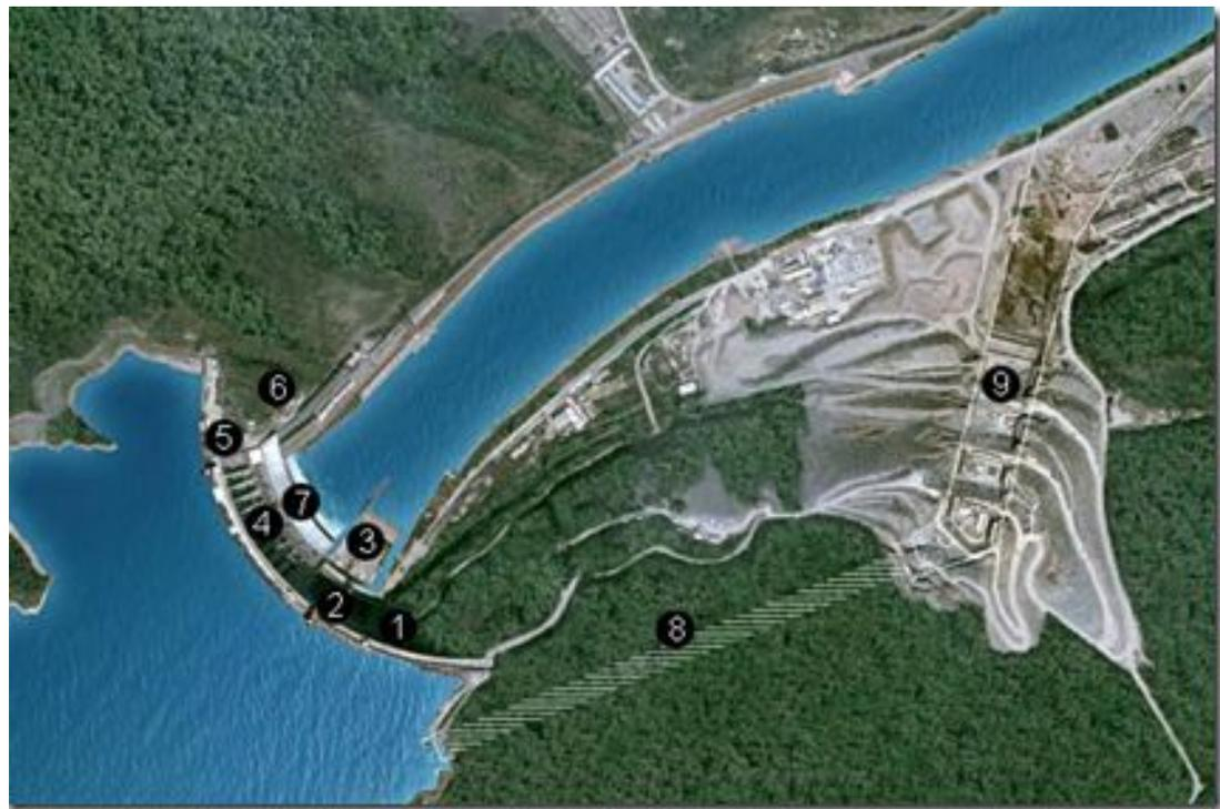
**Плотина: бетонная арочно-гравитационная высотой 245, длиной 1066, шириной в основании 110, по гребню — 25 метров. Включает левобережную глухую часть длиной 246,1, станционную часть длиной 331,8, водосбросную часть длиной 189,6 и правобережную глухую часть длиной 298,5 метра. Для ее сооружения потребовалось 9 075 000 кубометров бетона.**
