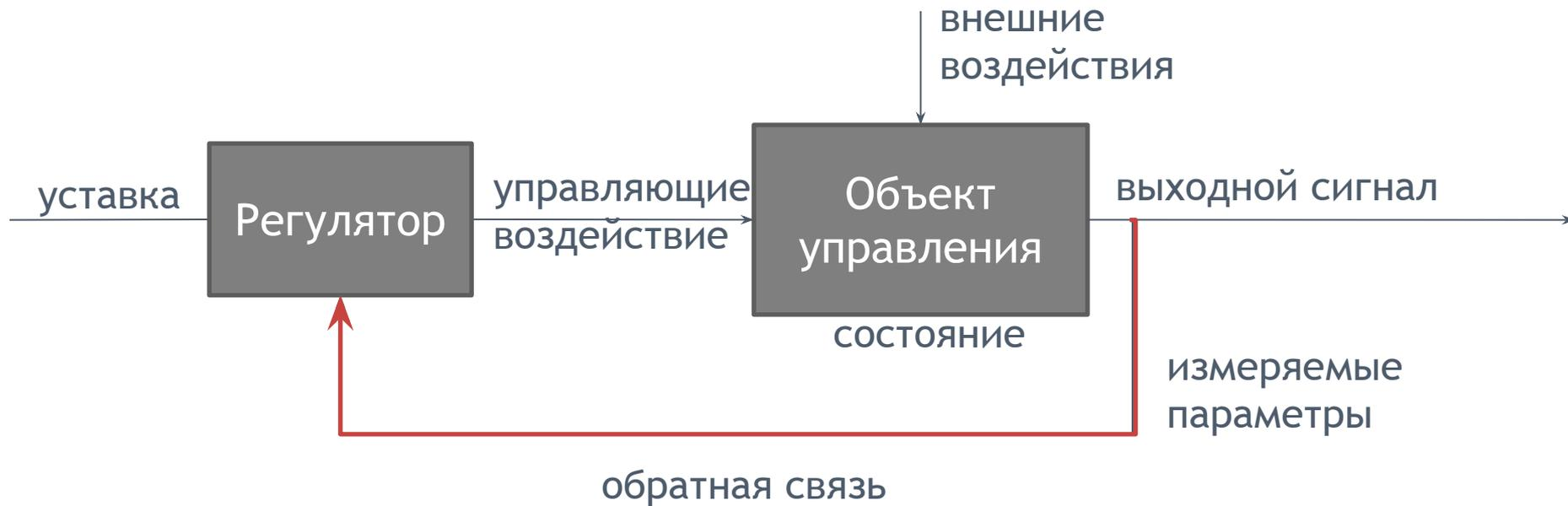
**Регулятор** - система, вырабатывающая с помощью обратной связи управляющие воздействие
