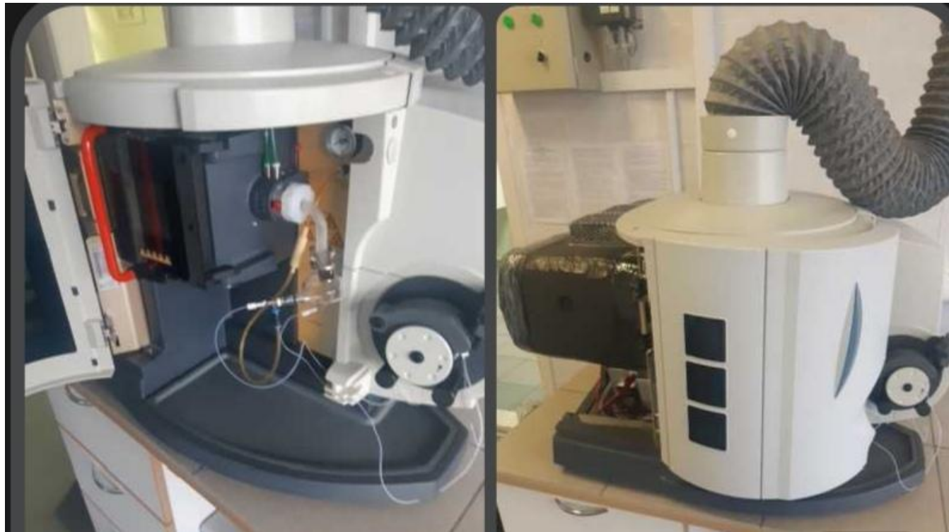
Рисунок 3. -Атомно-эмиссионный спектрометр с индуктивно связанной аргоновой плазмой
